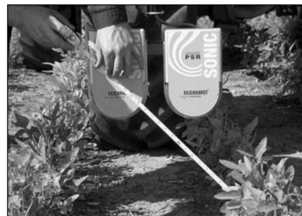
Afbeelding 133: Sensorrichting „Rijspoor overkruis“
