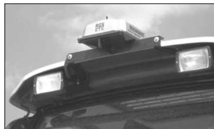
Afbeelding 18: RGS-RTK op montageplaat
