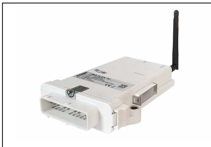
Fig. 4: ISO FLEX module
