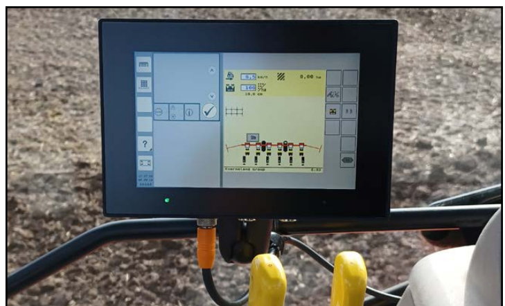
Abb. 1: SMART COMMAND-Terminal 7" mit ISOBUS-Maske
