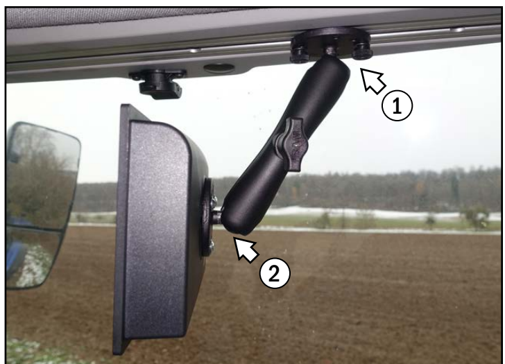
Abb. 10: Terminal im Fahrzeug montiert
