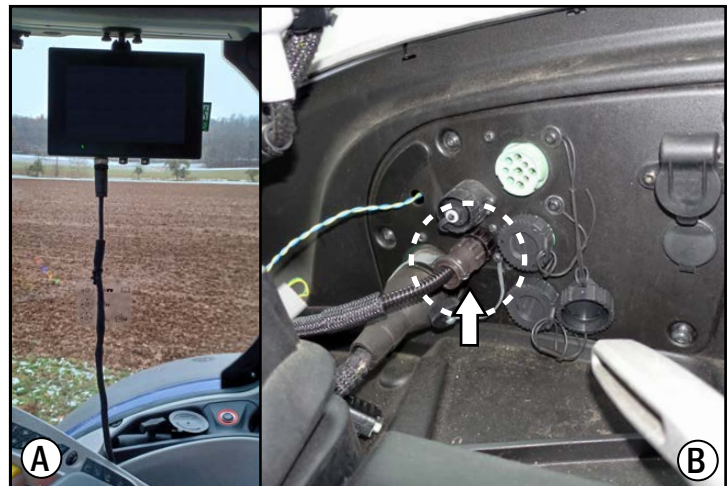
Abb. 12: Terminal an InCab-Steckdose des Fahrzeugs anschließen
